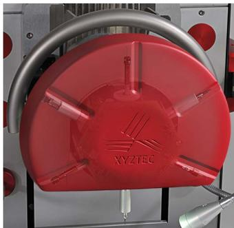
搭配6個傳感器的旋轉測量模組RMU, 最大測力範圍可達 200 公斤, 再也不需要手動更換模組
